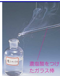
図6 塩化水素とアンモニアの反応
