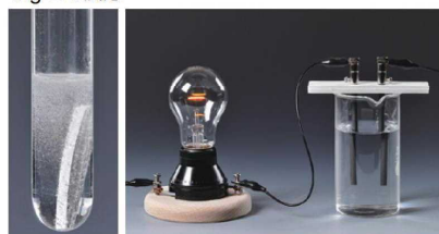
【弱酸の例】 0.1 mol/L 酢酸水溶液 Mgとの反応
