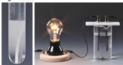
▲図7 強酸・弱酸の反応性と電気伝導性
