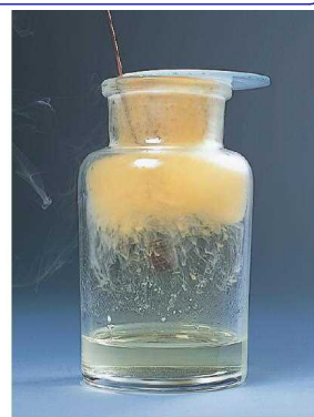
▲図3 銅と塩素の反応 気体の塩素中に熱した銅線を入れると、激しく反応して塩化銅(II)を生成する。
