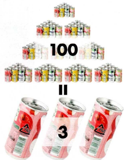
▲図 エネルギーの比較 ボーキサイトからアルミニウム缶を3個つくるエネルギーで、再生アルミニウム缶を約100個つくることができる。
