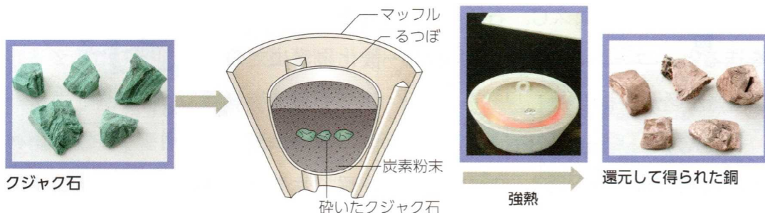
▲図 実験室での銅の製造 銅を含む鉱石の1つであるクジャク石を砕いて1 cm 角程度の大きさにする。これと炭素粉末をマッフルに入れて混ぜ，マッフルで強熱すると，還元されて銅が得られる。
