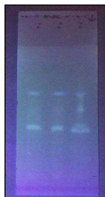
図6 TLCに紫外線を照射した様子
