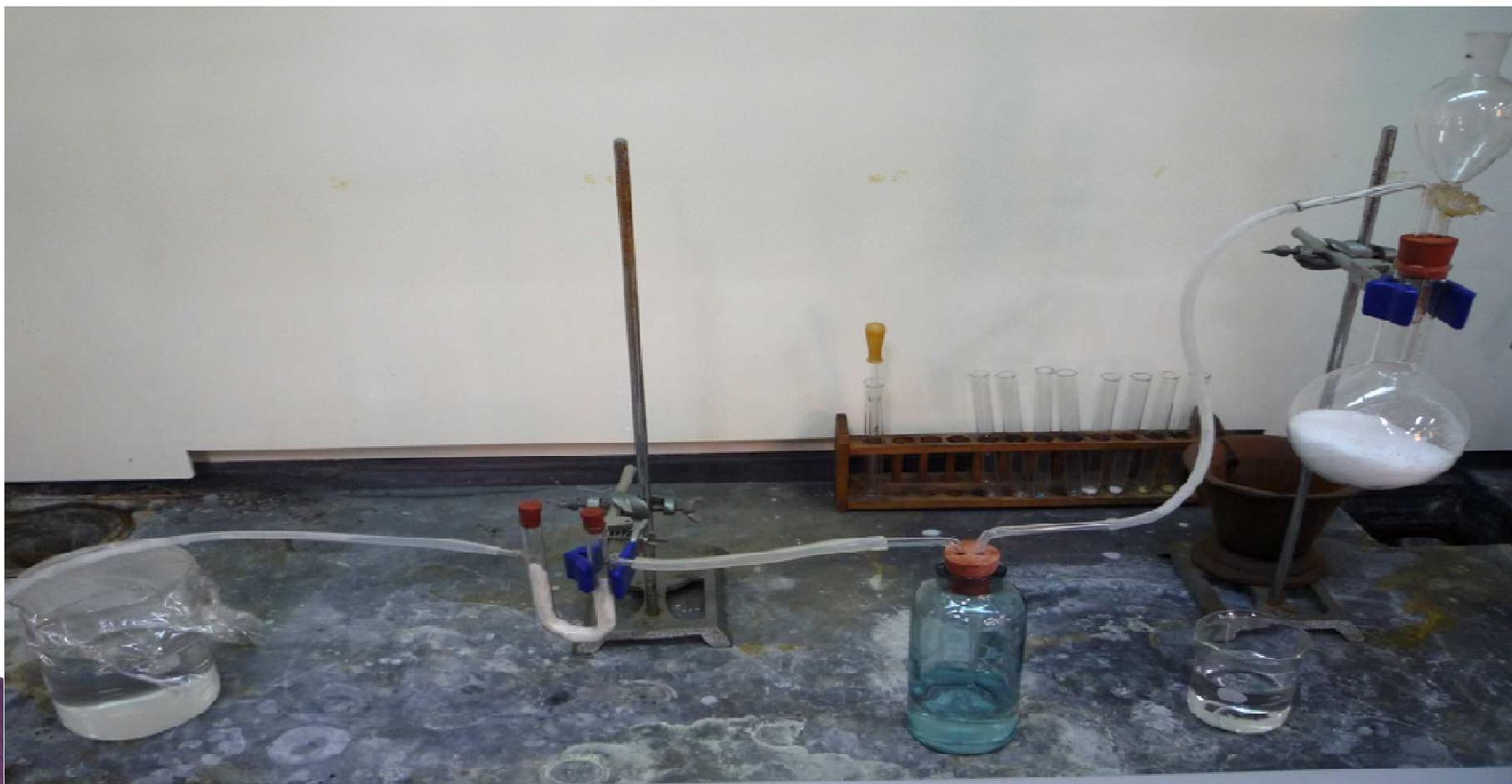
2.沈殿を生じた硫化亜鉛の水溶液を吸引ろ過し、水洗する
