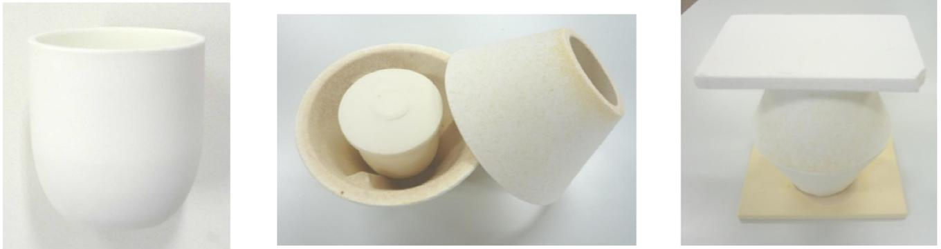
図5 アルミナ製のるつぼをマッフル炉に入れ、炉床板でふたをしている様子
