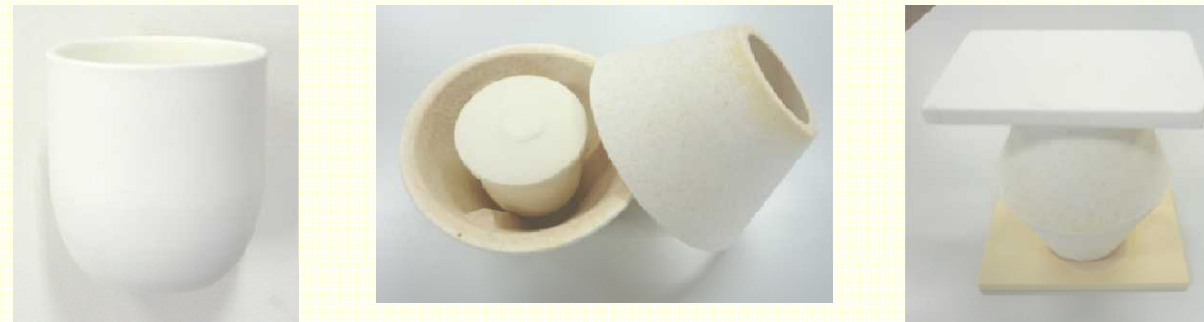
図3 アルミナ製のるつぼをマッフル炉に入れて炉床板でふたをしている様子
