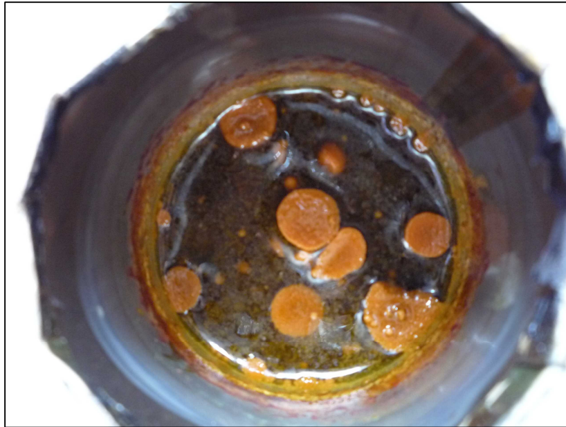
(図5：図4からさらに点火、消火を行ったときの様子。固形物が確認できる)
